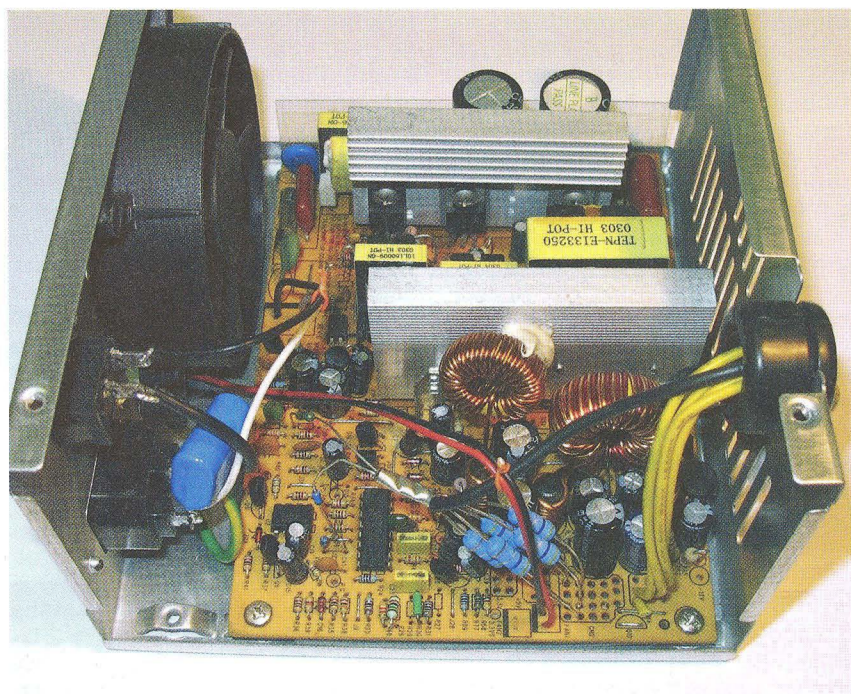
Obr. 5. Vnitřní uspořádání upraveného zdroje
